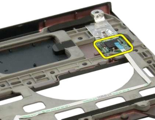
15. Wyjmij czytnik linii papilarnych z podpórki dłoni.
