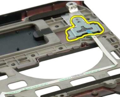
15. Wyjmij czytnik linii papilarnych z podpórki dłoni.
