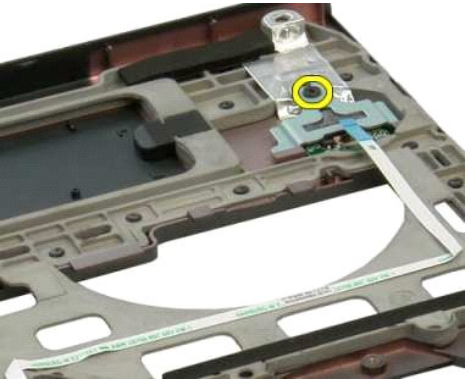
14. Wyjmij wspornik czytnika linii papilarnych.
